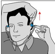
Für den korrekten Sitz, ziehen Sie das Ohr nach oben und drücken den Stöpsel in den Gehörgang.
